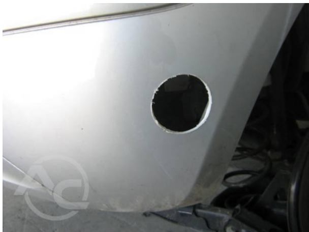
Рис. 1.3.1 Изготовление отверстия в бампере
