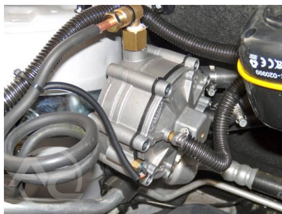
Рис. 1.3.26 Подключение редуктора
