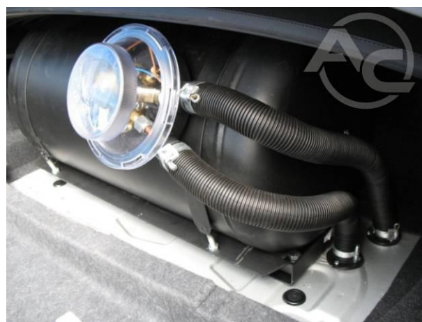
Рис. 1.3.15 Общий вид газонепроницаемых шлангов
