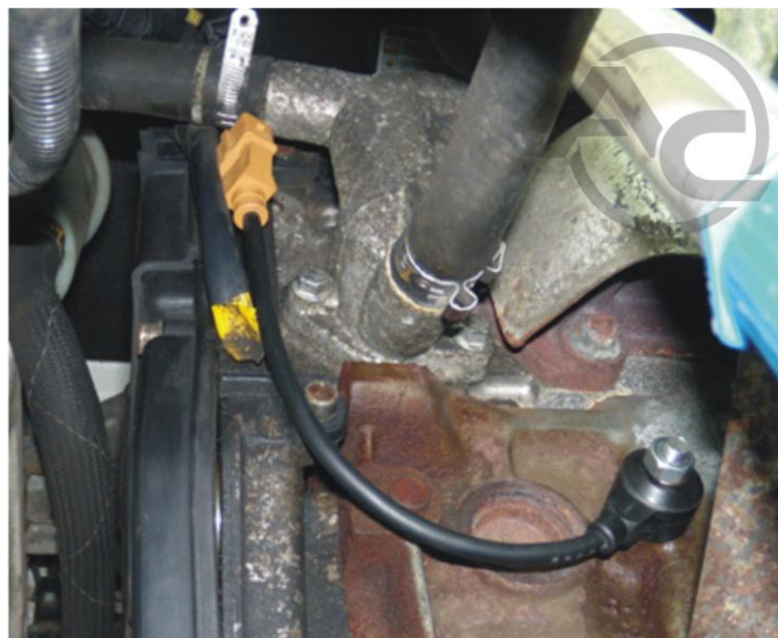
Рис. 1.3.32 Пример монтажа датчика детонации на блоке двигателя.
