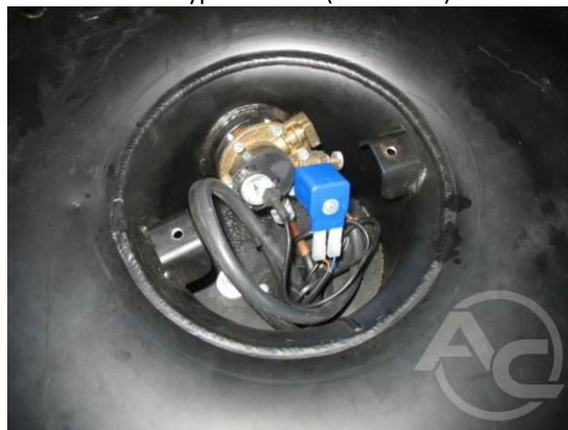
Рис. 1.3.19 Внешний вид подключенного мультиклапана
