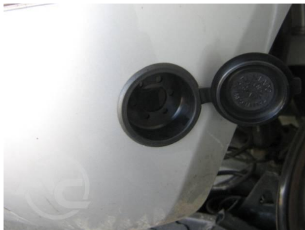
Рис. 1.3.2 Монтаж крышки заправочного клапана
