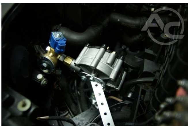
Рис. 1.3.25 Крепление редуктора
