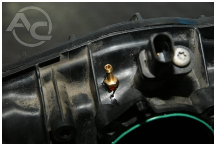
Рис. 1.3.39 Сопло разрезения, установленное в коллекторе
