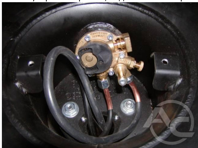
Рис. 1.3.18 Внешний вид мультиклапана
