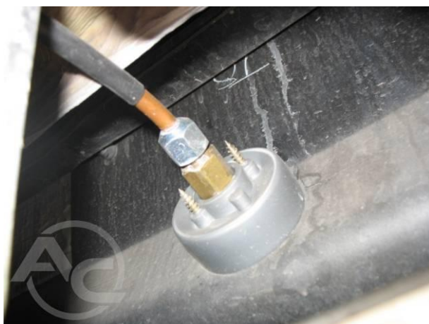
Рис. 1.3.3 Внешний вид заправочного клапана с внутренней стороны
