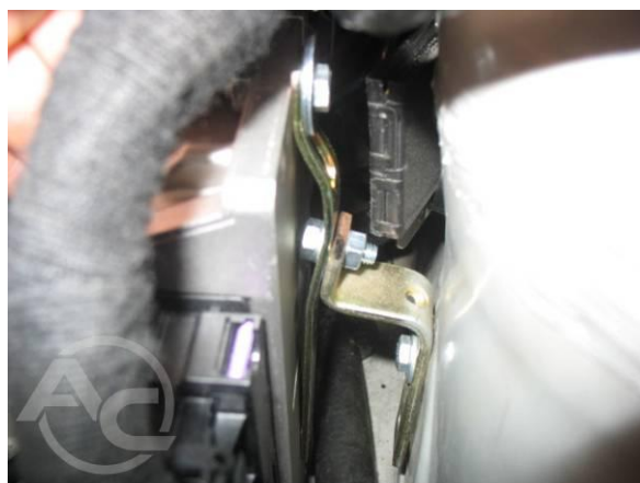
Рис. 1.3.36 Внешний вид крепления контроллера
