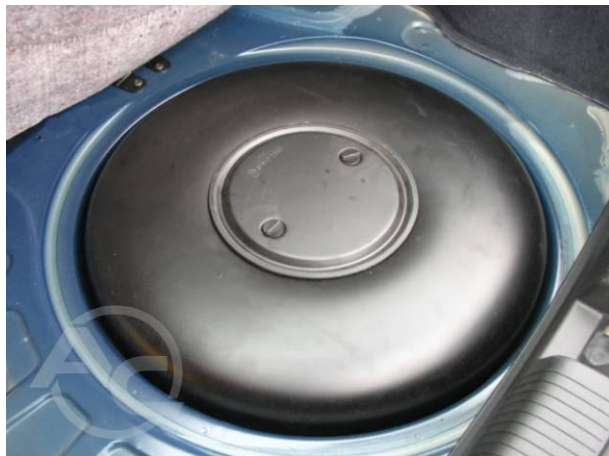
Рис. 1.3.10 Внешний вид установленного бака
