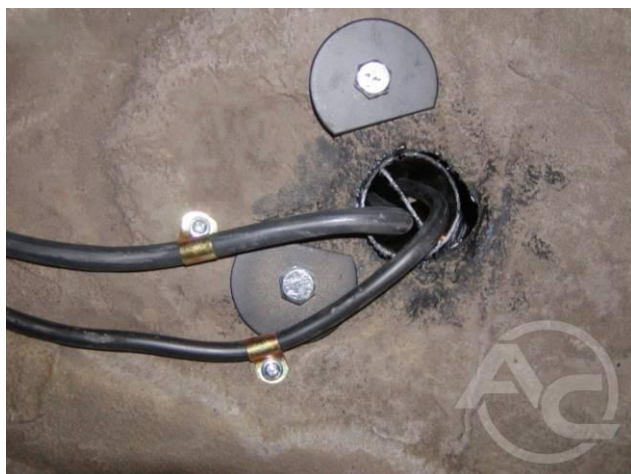
Рис. 1.3.20 Прохождение газопроводов через шасси
