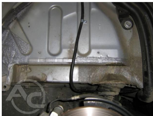
Рис 1.3.6 Крепление шланга заправки
