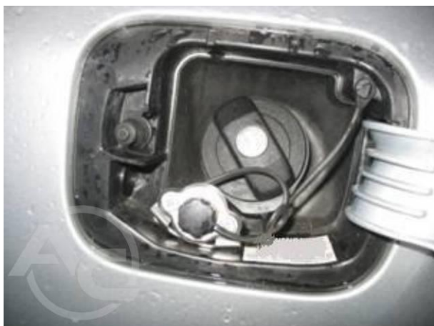
Вид 1.3.5 Заправочный клапан в углублении заливного отверстия дизельного топлива
