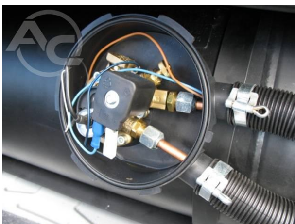
Рис. 1.3.14 Общий вид установленного мультиклапана
