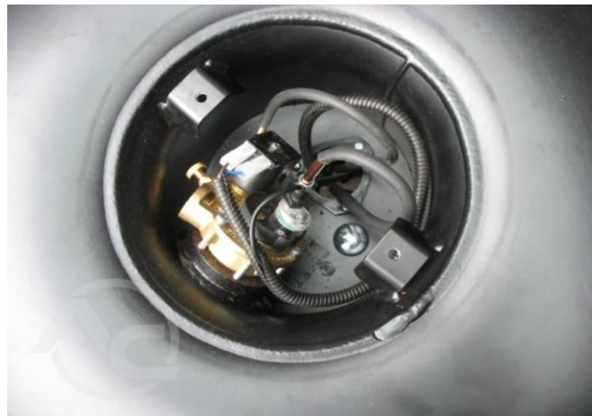
Рис. 1.3.11 Внешний вид мультиклапана
