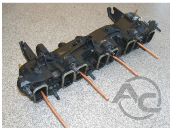
Вид 1.3.38 Место монтажа направленных сопел (вид изнутри канала коллектора)
