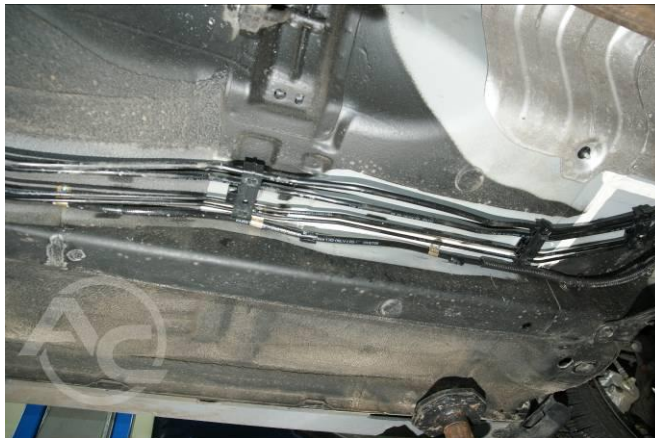
Рис. 1.3.24 Крепление с помощью металлических хомутов.
