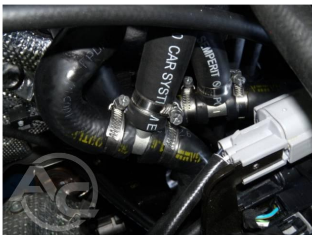
Рис. 1.3.27 Подключение редуктора к системе охлаждения
